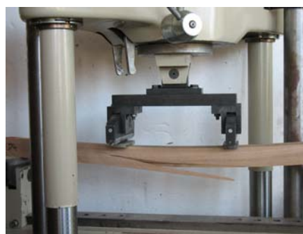
Obr. 6: Porušení dubového řeziva v tahové oblasti
