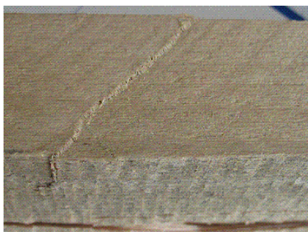
Obr. 5: Porušení bukového řeziva v tlakové oblasti
