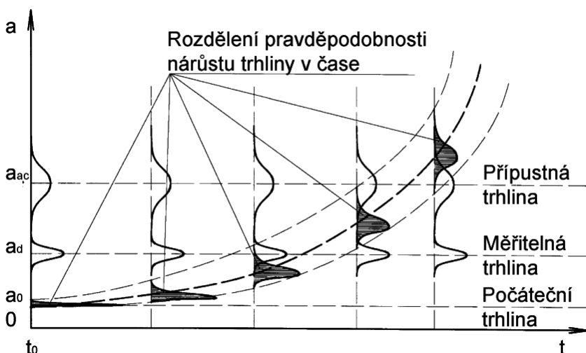
Obr.2: Pravděpodobnostní průběh nárůstu únavové trhliny v čase
