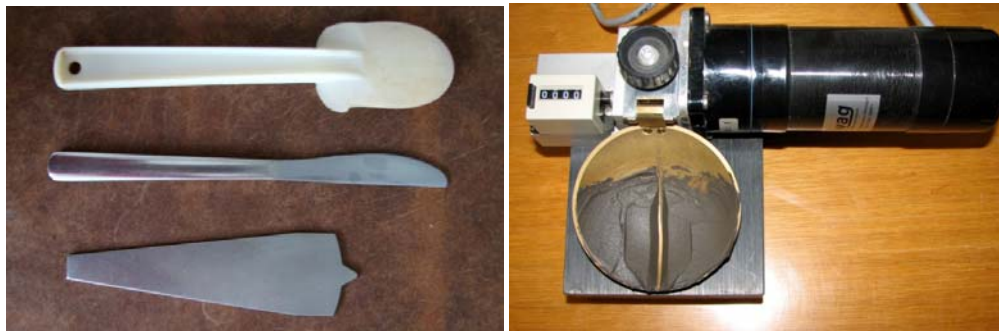
Obr. 1a: (vlevo) Štěrka, nůž a vyřezávací nůž; Obr. 1b: (vpravo) Casagrandeho přístroj s rýhou uprostřed misky před slitím obou koláčků
