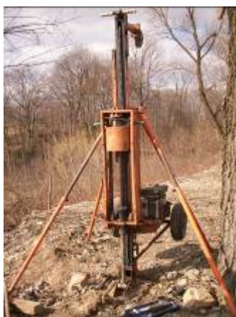
Obr. 3: Těžká dynamická penetrační souprava systému Borros
