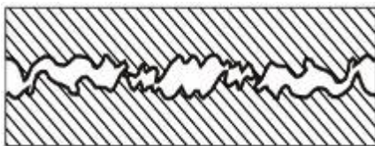
Obr. 12: Schématický model dotykové plochy dvou desek (A. Myslivec et al., 1970)
