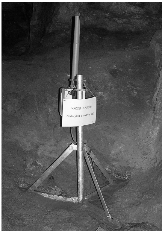
Obr. 4 Instalace LDM v komoře K2
