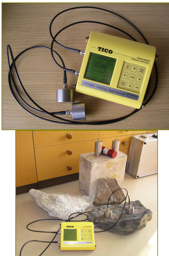
Obr. 2 Přenosná ultrazvuková aparatura TICO firmy Proceq (Švýcarsko)
