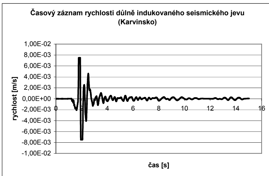
Obr.3: Časový záznam rychlosti kmitání důlně indukovaného seismického jevu (Stonava,Karvinsko).
