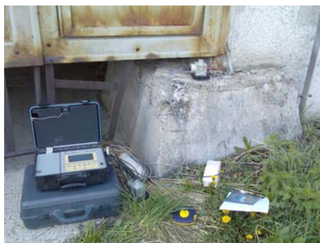
Obr. 4 Stanovisko č. 6 (senník JRD) - seizmograf UVS 1504 a seizmosnímače švédskej firmy Nitro Consult a stanovisko č. 2 (obytný dom č. 243 Vyšná Šebastová) s registračnou seizmickou aparátúrou ZEB/SM-3C a seizmosnímačom firmy Orica Mining Services, SRN
