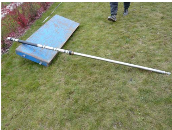
Obr. 2 Sonda vlnové akustické karotáže FWS50
