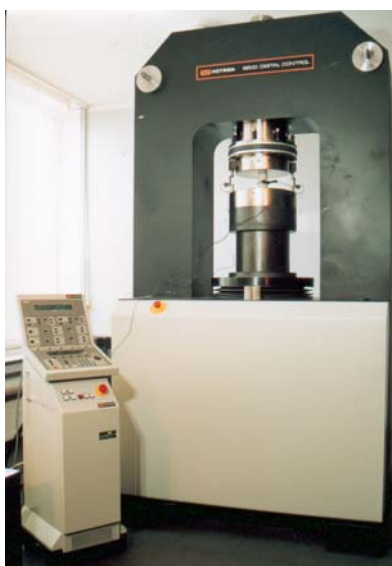
Rys. 5 Maszyna wytrzymałościowa INSTRON 8500 Rock Testing System
