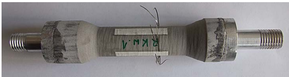
Rys. 4 Próbka przygotowana do testu bezpośredniego, jednoosiowego rozciągania
