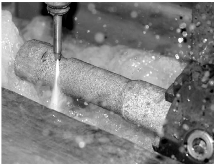
Rys. 2 Wycinanie próbki skalnej metodą AWJ (Sitek i in., 2006).
